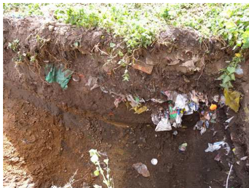
Figura 1 – Perfil de plásticos utilizados para tapar um fosso ornamental em 1980 no Jardim Tudor do Parque Cedars, Broxbourne, Reino Unido
