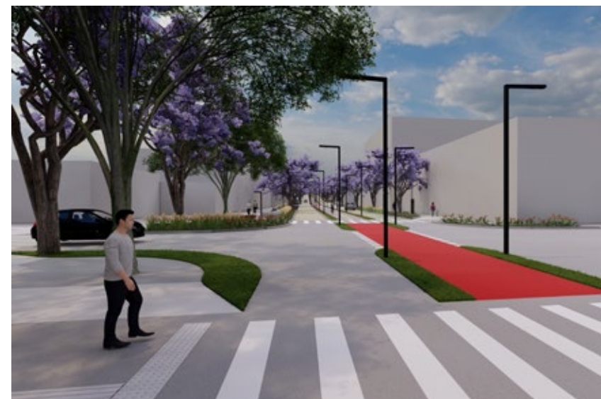
Figura 5 – Cruzamento elevado e ciclovias
