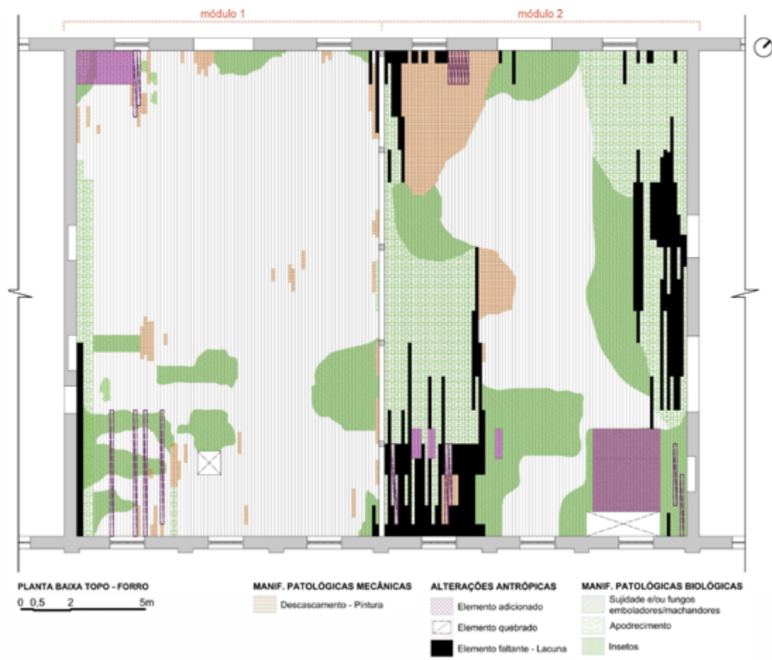
Figura 11: Mapa de danos do forro entre o primeiro pavimento e o sótão.
