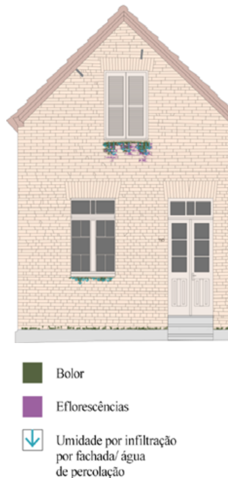
Figura 16: Mapa de degradação da fachada da residência nº 2, de número 118
