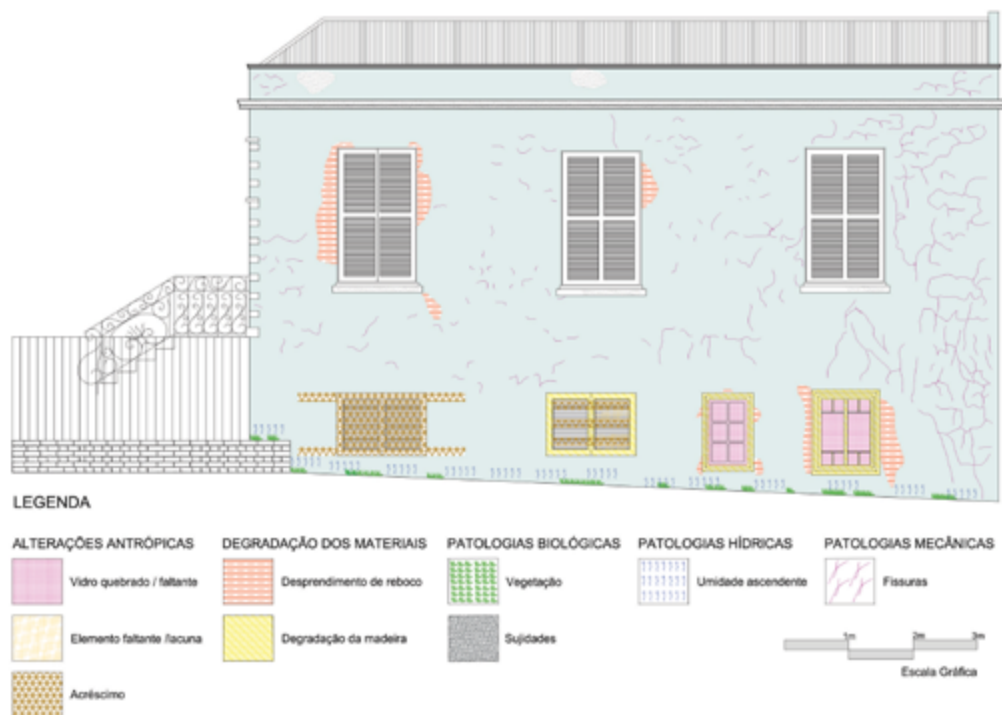
Figura 15: Mapeamento das degradações da fachada leste
