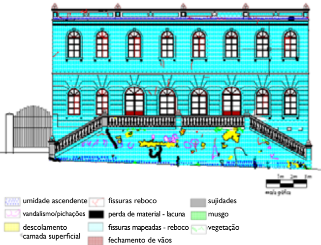
Figura 16: Mapeamento de danos – fachada oeste.
