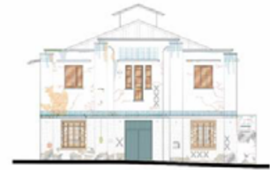
Figura 14: Exemplo de mapeamento de deterioração de fachada (fachada norte).
