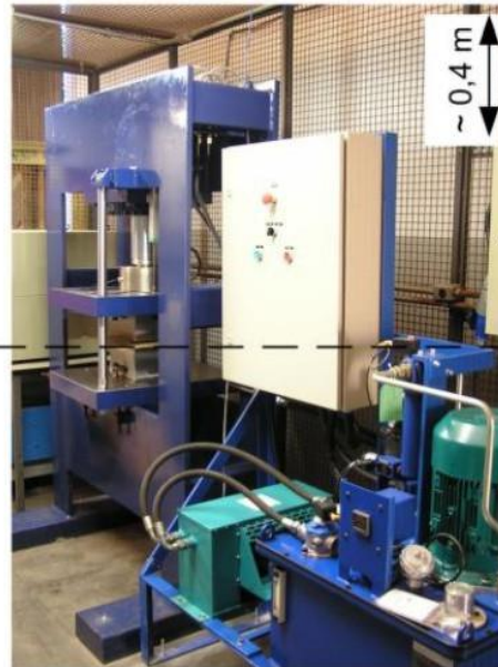
b) prensa hidráulica laboratorial. Força máxima de 1,47 MN
