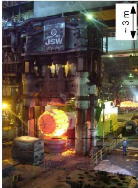
a) prensa hidráulica industrial. Força máxima de 140 MN (MURAI et al. 2008)
