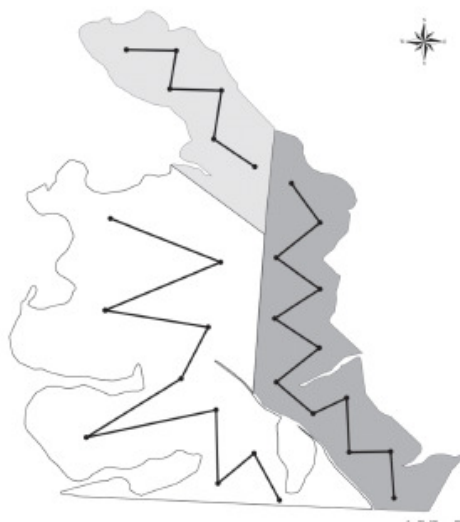
Figura 4: Percurso em “zig-zag” para coleta de subamostras em 3 áreas distintas de uma propriedade
