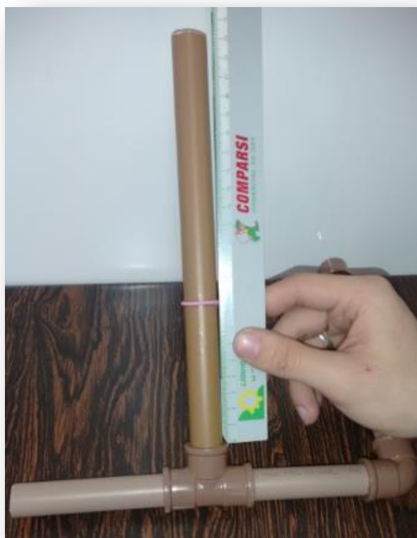
Figura 09: Pegar o balão e cortar apenas o anel dele e posicionar no tubo maior a uma distância de 8,5 cm do “tê”.
