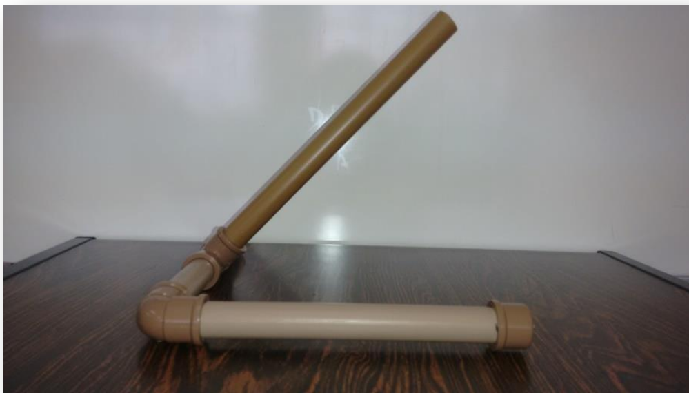
Figura 08: Bancada com o ângulo de 45^\circ
