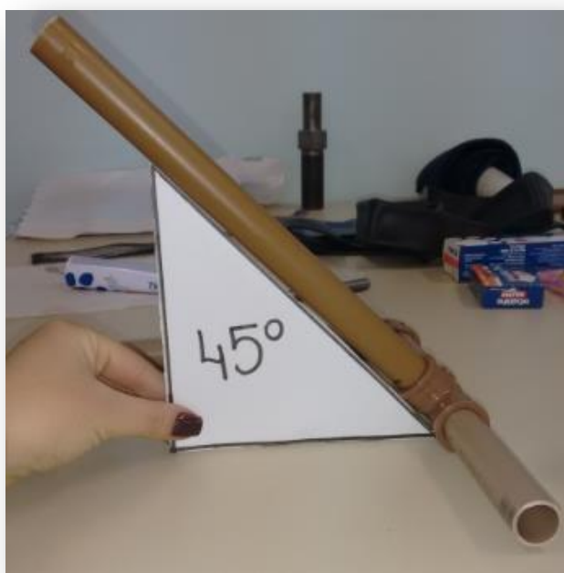
Figura 07: Depois de colar os cantos garantir um ângulo de 45° com uma face plana.
