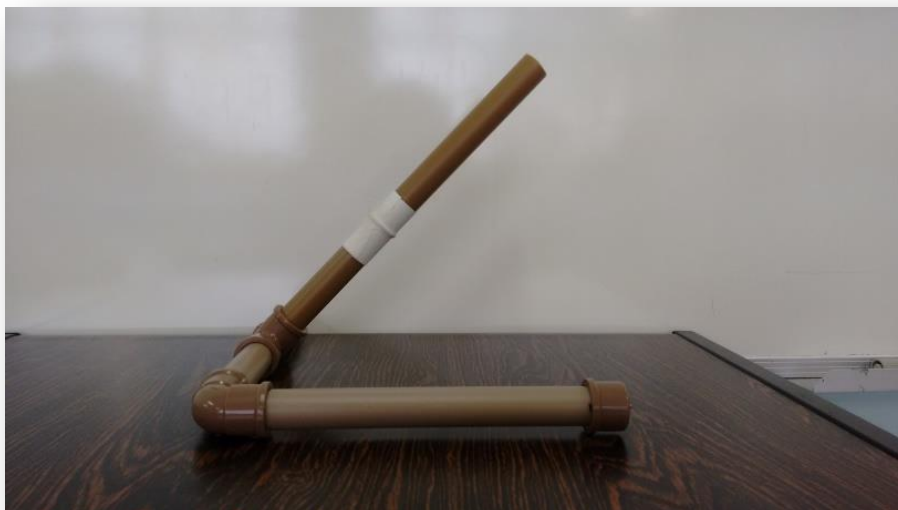
Figura 10: Passar uma volta de fita esparadrapo deixando o anel do balão de aniversário centralizada na marca de 8,5 cm, deixar o esparadrapo totalmente liso, para não dificultar no lançamento do foguete.
