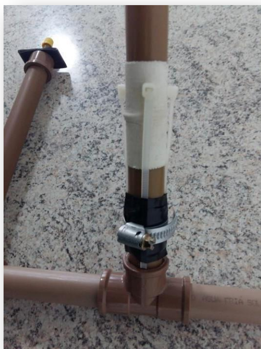
Figura 13: Para fazer o gatilho, coloque o foguete ou uma garrafa pet na posição de lançamento deixando a metade da boca da garrafa centralizada com o anel do balão. Passe fita dupla face no cano e depois alinhe as 4 dobradiça conforme a posição de lançamento do foguete em seguida passe fita isolante para fixar as abraçadeiras, depois coloque a abraçadeira de metal para garantir 100% a fixação.
