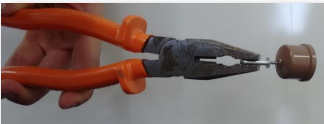
Figura 11: Fazer um furo com um prego ou rebite em um dos “Cap” para depois com a tesoura abrir até a passagem justa do ventil.
