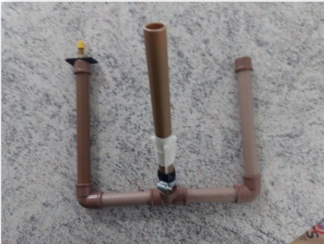
Figura 14: Gatilho de liberação do foguete. Faça dois furos no cano branco de PVC e amarre 3m de barbante.
