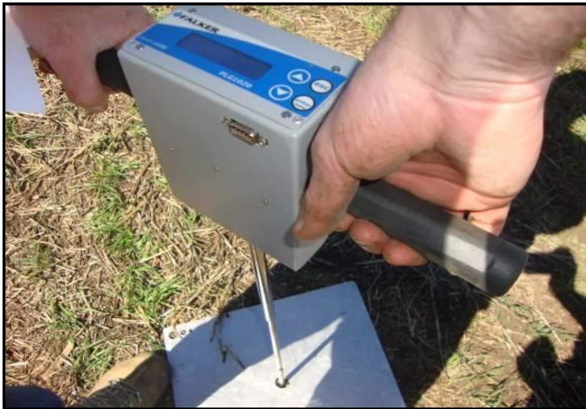
Figura 11- Coleta dos dados de compactação do solo, medidor eletrônico, (PenetroLog PLG1020). Bom Jesus – RS.
