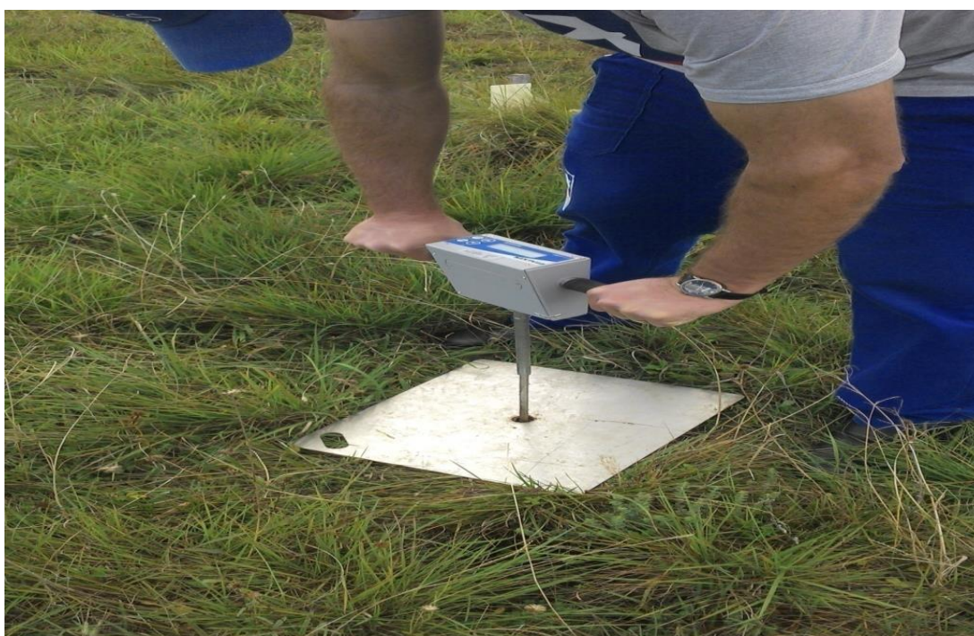
Figura 6- Coleta dos dados de compactação do solo, medidor eletrônico (PenetroLog PLG1020).
