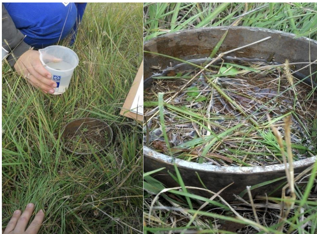
Figura 7- Cilindro introduzido no solo a 7,5cm de profundidade, adicionado 144 ml de água e anotado tempo transcorrido para infiltração de todo o líquido no solo.
