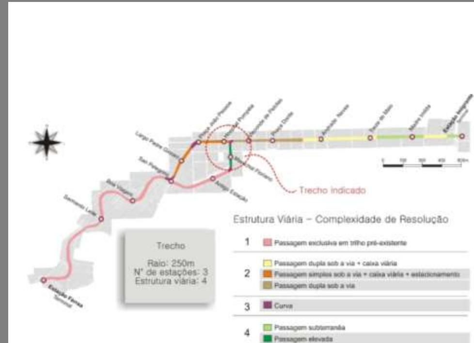
Figura 1 – Estrutura viária – definição da área de intervenção
