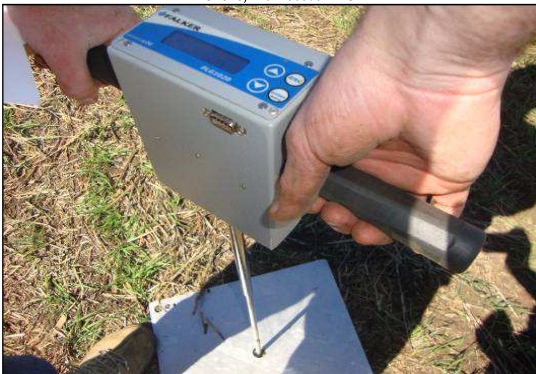
Figura 16 – Coleta dos dados de compactação do solo, medidor eletrônico (PenetroLog, PLG1020). Bom Jesus – RS
