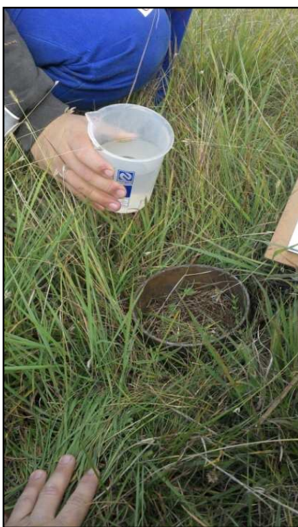
Figura 12 – Cilindro introduzido no solo a 7,5cm de profundidade, adicionado 144ml de água e anotado o tempo transcorrido para a infiltração de todo o líquido no solo
