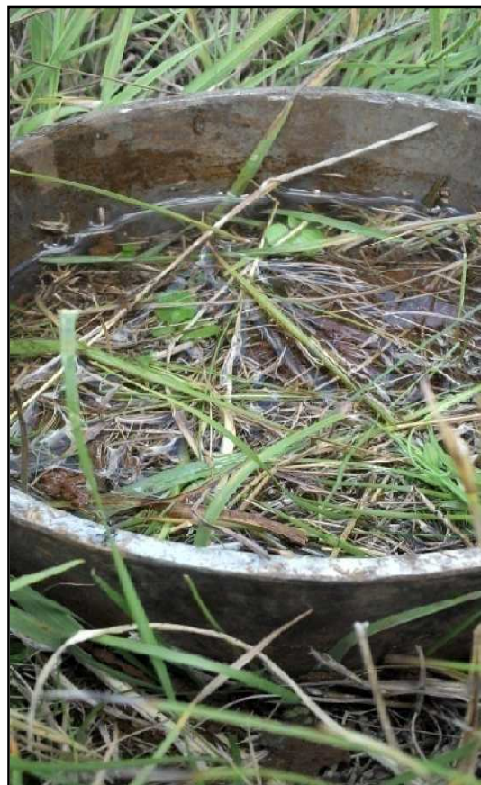
Figura 12 – Cilindro introduzido no solo a 7,5cm de profundidade, adicionado 144ml de água e anotado o tempo transcorrido para a infiltração de todo o líquido no solo
