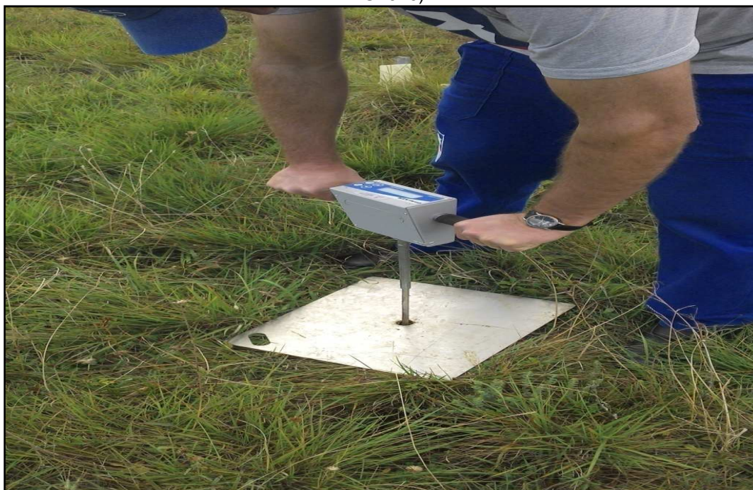
Figura 11 – Coleta dos dados de compactação do solo, medidor eletrônico (PenetroLog PLG1020)
