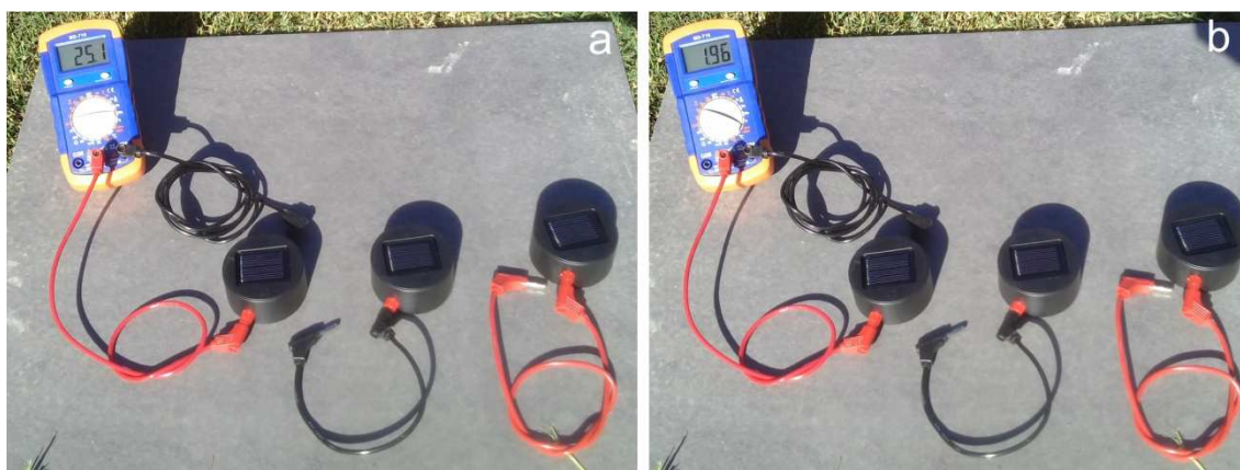
Figura 15 – Um dos módulos fotovoltaicos conectados em série com o multímetro. (a) leitura de tensão e (b) corrente
