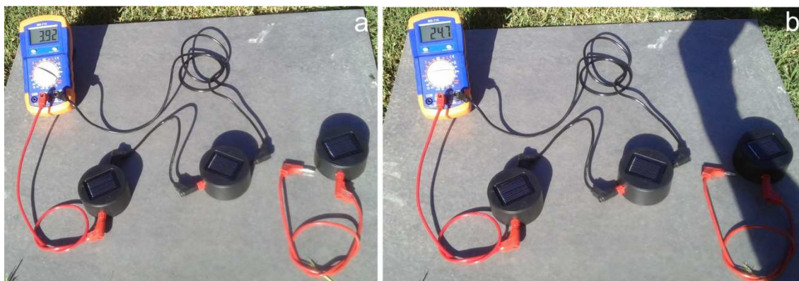
Figura 16 – Dois módulos fotovoltaicos conectados em série com o multímetro. (a) leitura de tensão e (b) corrente
