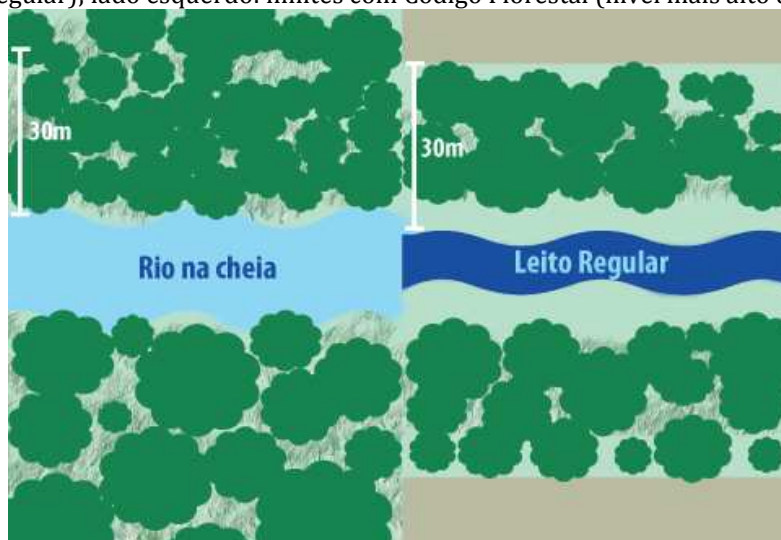
Figura 1 – Quadro demonstrativo do limite APP: lado direito: após o Código Florestal 2012 (leito regular); lado esquerdo: limites com Código Florestal (nível mais alto do rio)
