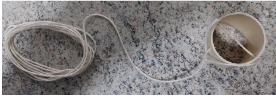
Figura 14 - Para o gatilho de liberação do foguete, faça dois furos no cano branco de PVC e amarre 3 m de barbante.
