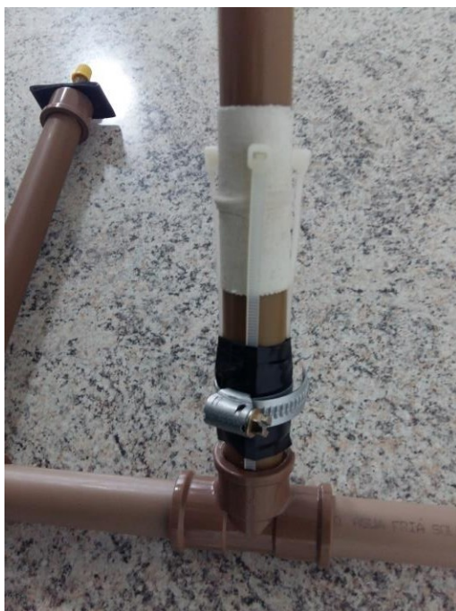
Figura 13 - Para fazer o gatilho, coloque o foguete ou uma garrafa pet na posição de lançamento deixando a metade da boca da garrafa centralizada com o anel do balão. Passe fita dupla face no cano e, depois, alinhe as 4 dobradiças conforme a posição de lançamento do foguete em seguida passe fita isolante para fixar as abraçadeiras, depois coloque a abraçadeira de metal para garantir 100% a fixação.
