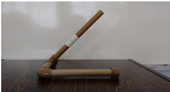
Figura 10 - Passe uma volta de fita esparadrapo deixando o anel do balão de aniversário centralizada na marca de 8,5 cm. Deixar o esparadrapo totalmente liso para não dificultar no lançamento do foguete.
