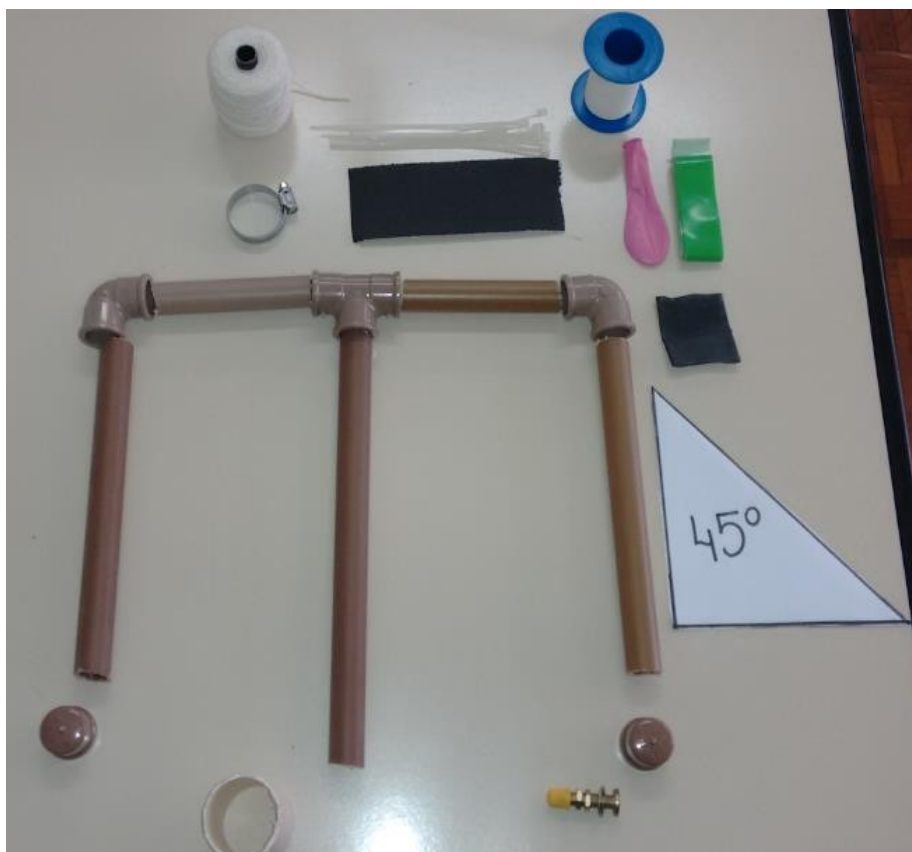
Figura 2 - Imagem dos materiais sugeridos para a construção da base de lançamento de foguetes.
