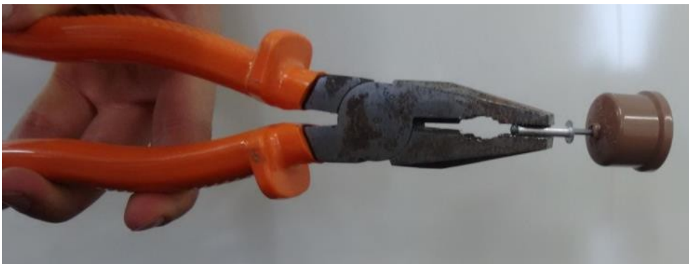
Figura 11 - Faça um furo com um prego ou rebite em um dos “cap” para depois, com a tesoura, abrir até a passagem justa do ventíl.
