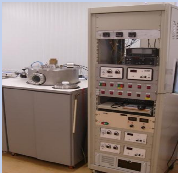
Figura 1a: Equipamento de magnetron sputtering do LESTT.
