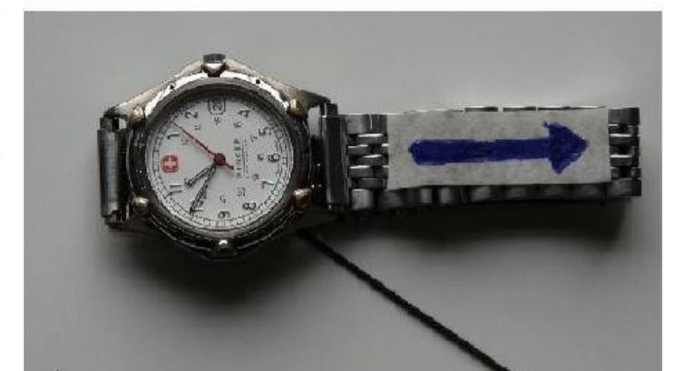
Figura 3: O ponteiro dos segundos volta a alinhar-se com o barbante, após ter se alinhado com a seta
