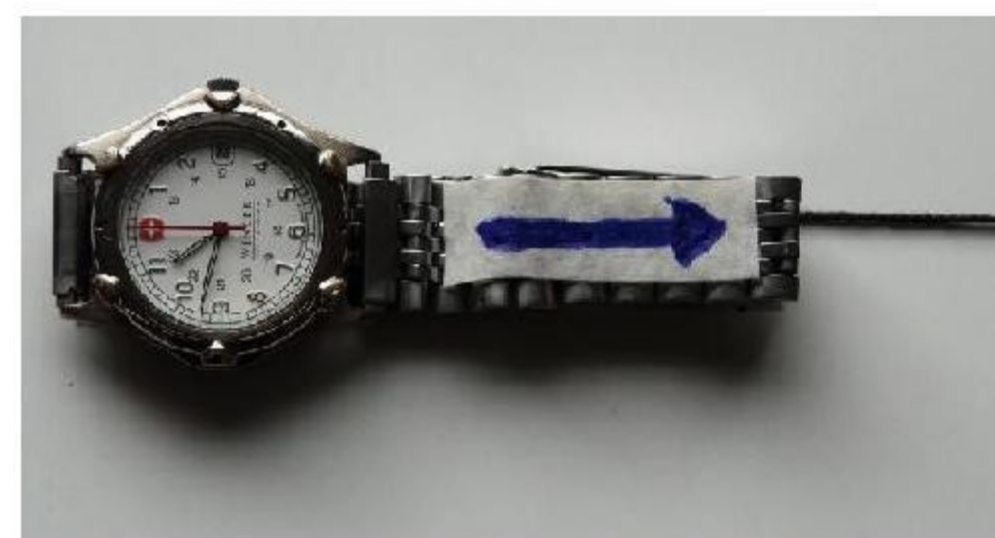
Figura 2: O ponteiro dos segundos está alinhado com o barbante e com a seta azul.
